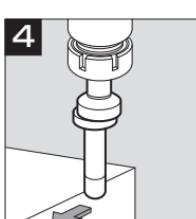
③の状態よりさらに微細送りで押し当てるとき、測定子が一定方向へスライドを始めます。このスライドを始めた位置から測定子の半径5mm(2mm)を考慮した位置が基準位置です。
