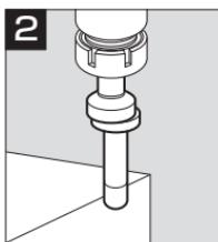
測定子を指で軽く押し、少し偏芯させ、400～600min<sup>-1</sup>で回転させてください。
