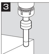
②の状態より加工物に測定子を接触させていくと、測定子の振れが少しずつ無くなり、静止したかのようになります。
